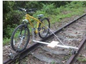
軌道自転車の試作と走行実験
